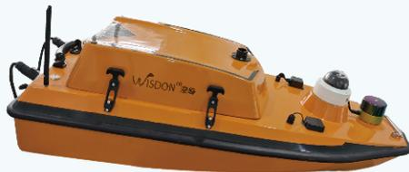
W120单体多功能无人船搭载功能强大，船体轻便，最大航速可达3.5m/s，吃水深度小于10cm适应浅滩作业，推进器涵道式设计有效防止水草、渔网缠绕，充分满足水文、水利、科研、环保、水务等领域的水文测量与地形测绘等需求。
