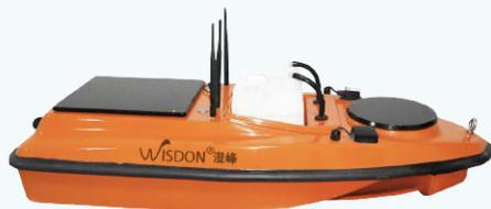
W100自动采样无人船船体小巧便携，10cm吃水适应浅滩作业，推进器涵道式设计有效防止水草、渔网缠绕，具备机动灵活地开展大范围水体的水样自动采集工作。可广泛应用于环保、水文、水利、水务、科研等领域采样。
