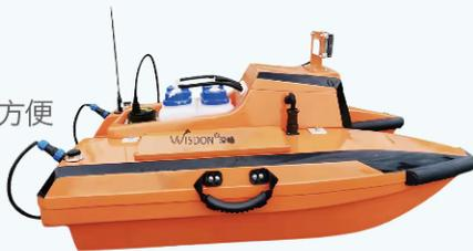
WD90水质监测采样无人船是新一代的精品无人船产品，船体小巧便携兼具自动采样与自动监测功能，推进器涵道式设计有效防止水草、渔网缠绕，具备机动灵活地实现大范围水体的水样自动采集与实时监测功能。可广泛应用于环保、水文、水利、水务、科研、渔政等领域。
